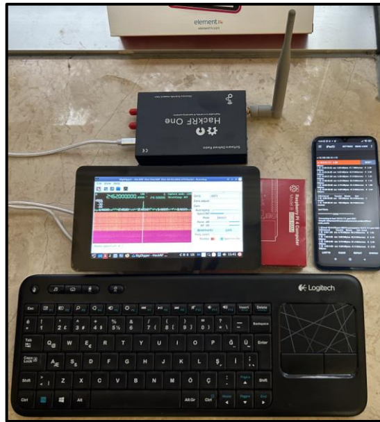
Şekil 3.3. HackRF One ve SigDigger programlarıyla oluşturulan sinyal izleme sistemi
