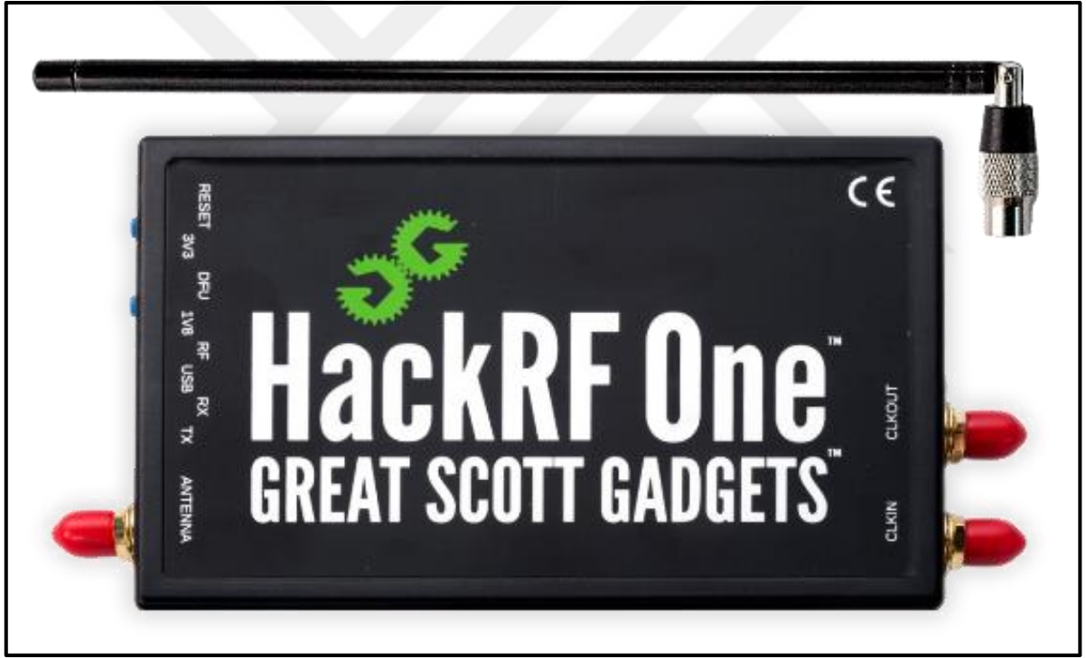
Şekil 3.12. HackRF One yazılım tanımlı radyo
