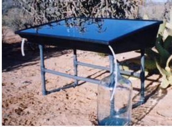
Şekil 3.7. Su arıtma sistemlerinin yapısı.
