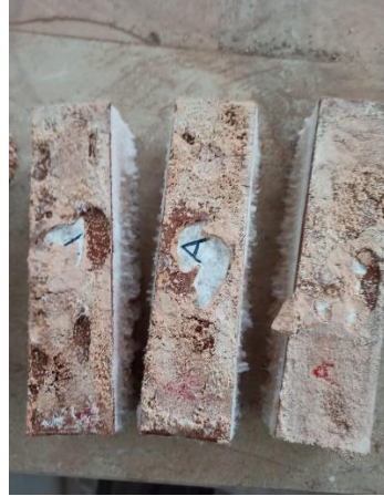
Şekil E.21. Sodyum silikat/sodyum hidroksit oranı 1/1 olarak kullanılan, 50gr yüksek fırın cürufu katkılı YA numunesinde kuma
