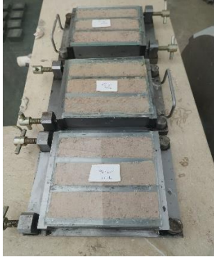
Şekil E.5. Kabuk suyu kullanılarak üretilen numuneler
