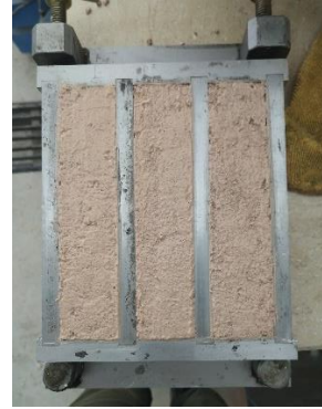
Şekil E.6. Kabuk suyu kullanılarak üretilen numuneler
