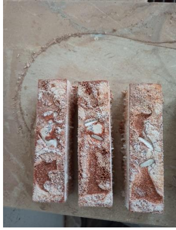
Şekil E.20. Sodyum silikat/sodyum hidroksit oranı 1/1 olarak kullanılan, puzolan katkısız M numunesinde kuma
