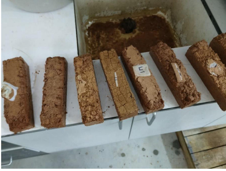
Şekil E.25. Kusma gözlemlenen numunelerde, 24 saat suda bekletildikten sonra oluşan bozulma
