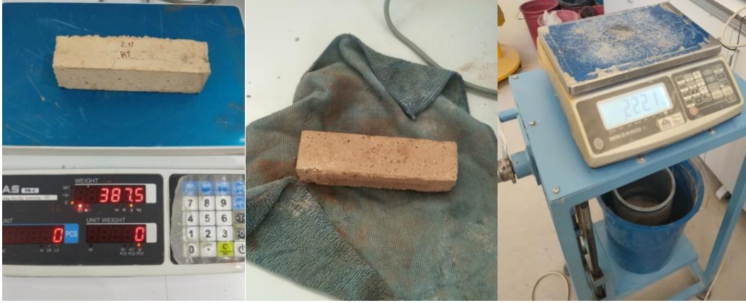
Şekil 4.8. Su emme oranı ve porozite tayini
