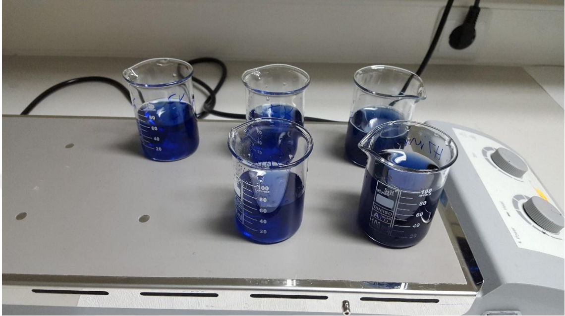
Şekil 2.2. Deneysel çalışmalarda kullanılan çok noktalı manyetik karıştırıcı.
