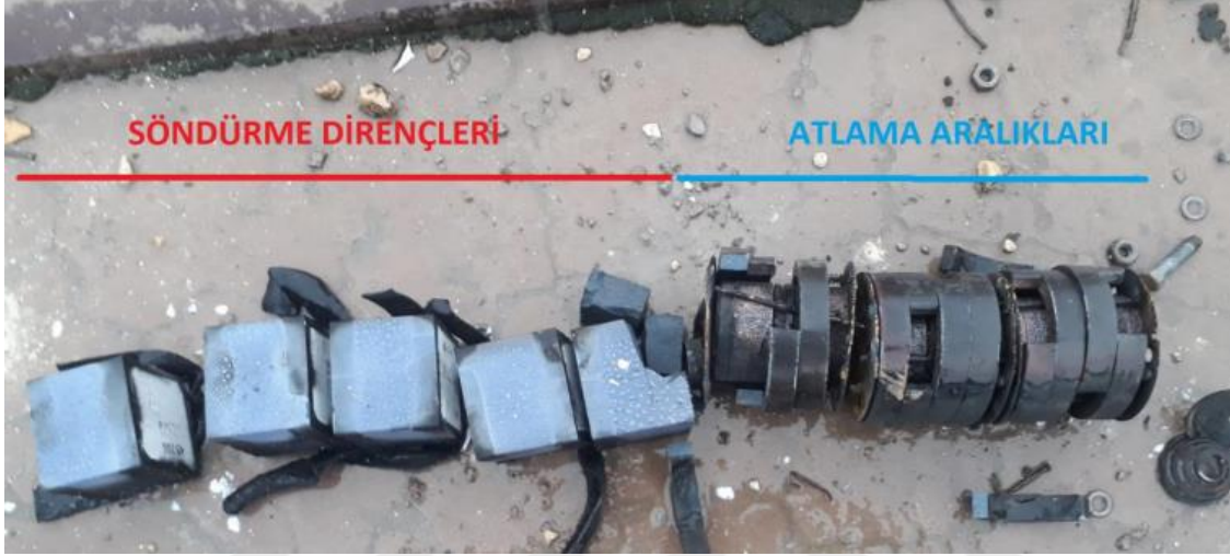
Şekil 4.23. Hasarlanan C faz parafudr içi
