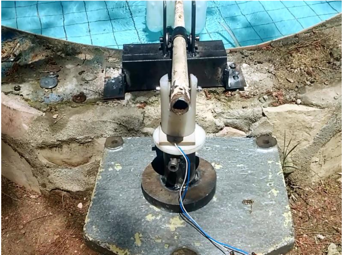
Şekil 6.5. Kare tipi PZT malzemenin silindir ile kaide arasındaki görüntüsü.
