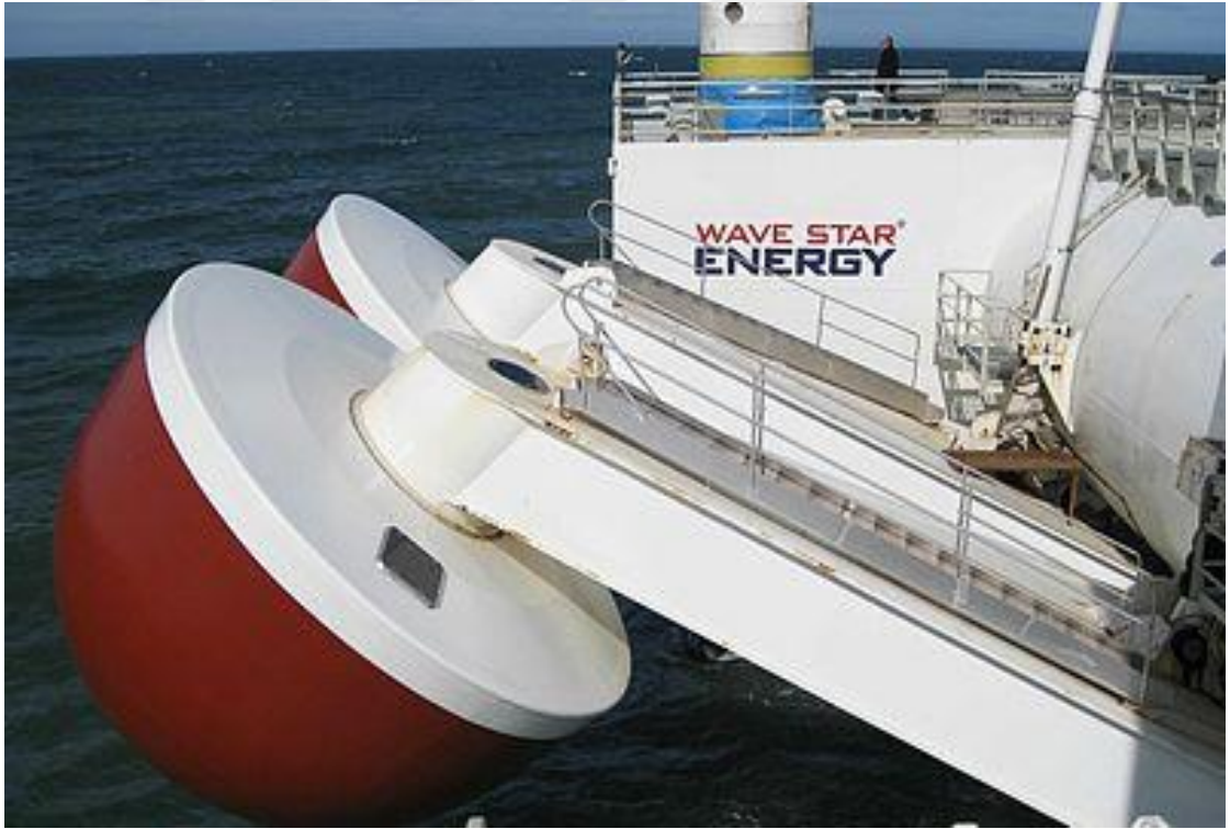
Şekil 4.31. Fırtınalı havalarda dubaların sabitlenmesi.
