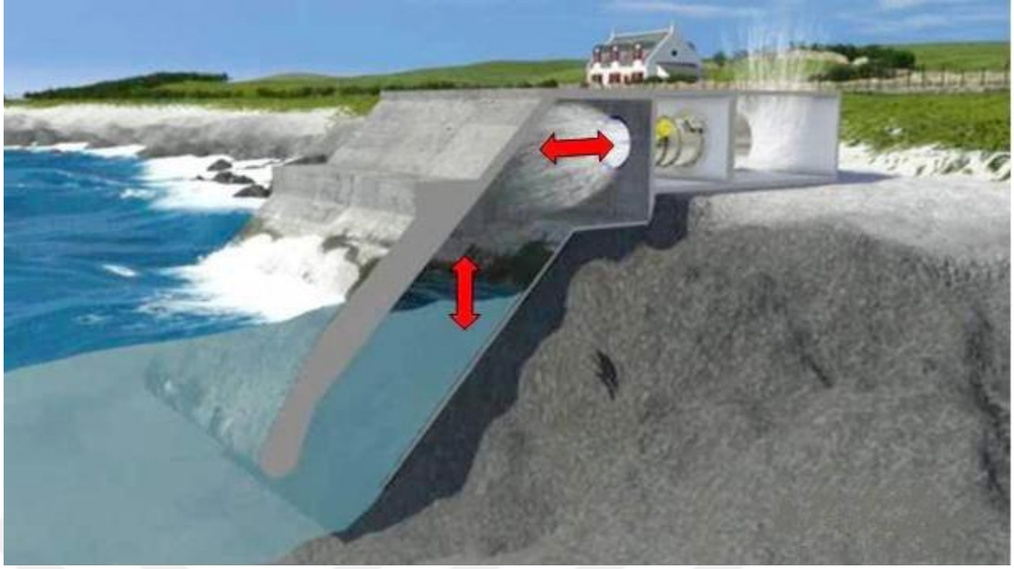
Şekil 4.2. OWC dalga enerjisi dönüşüm sistemi.
