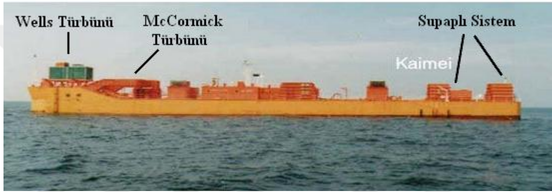
Şekil 4.27. Kaimei enerji dönüşüm sistemi.
