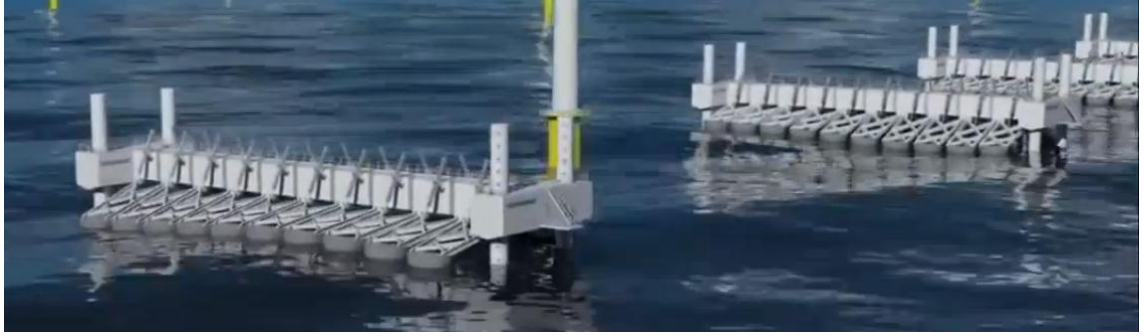
Şekil 4.32. Kırkayak duba enerji dönüşüm sistemi.
